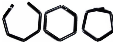
Slika 3. Tri odštampana lanca prikazuju kalibracije testova i preciznost prilagođavanja uglova poslije transformacije
