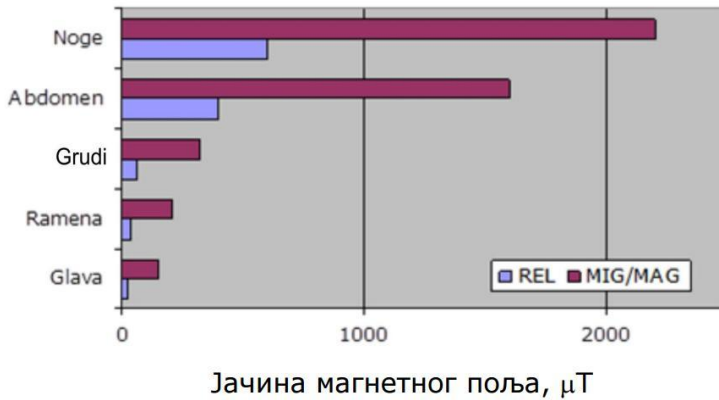
Slika 2. Jačina elektromagnetnog polja REL i MIG/MAG zavarivanja na različite delove tela
