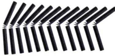
Slika 2. 4D štampanje sa zglobovima za prilagođavanje uglova
